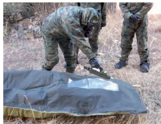
Control de la contaminación química externa en una baja transportada en un saco de bajas
