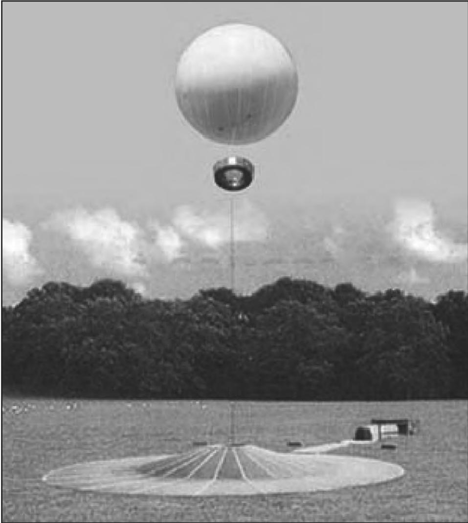
**Figura 8.**–Globo aerostático anclado, con sensores.
