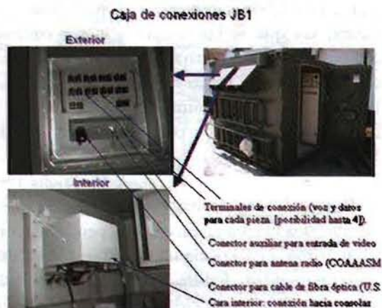
Figura 3. Caja de conexiones JB1 del PC de DT Skydor dispuesto para conectar hasta 4 Piezas 35/90
