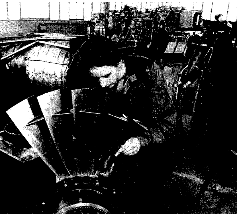
Un técnico de la Rolls Royce monta los álabes del ventilador de un motor "Pegaso".
