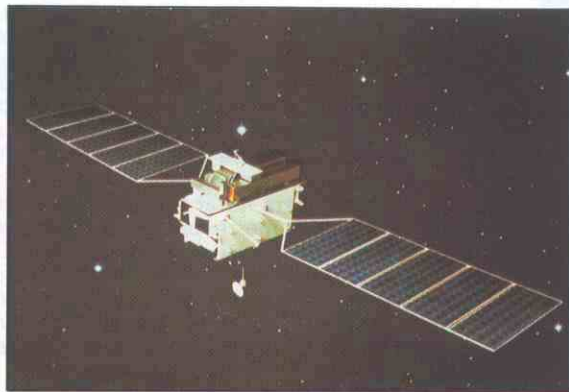
La plataforma europea recuperable Eureka será lanzada para misiones de seis meses en órbita y recuperada por la nave espacial a finales de la presente década. Su primera misión está destinada principalmente a experimentos de microgravedad, si bien se puede utilizar también para la observación de la tierra y de la astronomía.
