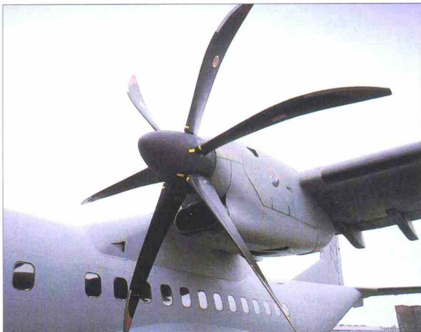
La planta de potencia del CASA 295 se compone de dos motores Pratt&Whitney Canada PW 127G equipados con hélices Hamilton de seis palas fabricadas en materiales compuestos.
