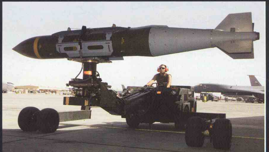
En la fotografía superior vemos un U-2 Dragon Lady repostando después de una misión realizada el 13 de abril. El U-2 proporciona imágenes e inteligencia de señales prácticamente en tiempo real. USAF. A la derecha, GBU-31 JDAM (Joint Direct Attack Munition). Bomba guiada por GPS de 1.000 kg. USAF.
