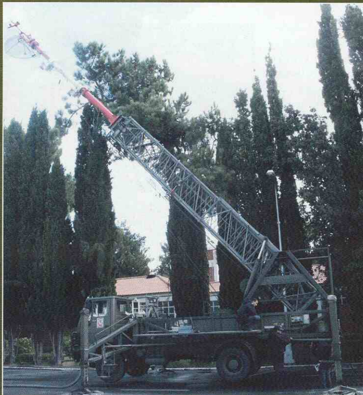
Colocadas ya las antenas, se despliega la torre.
