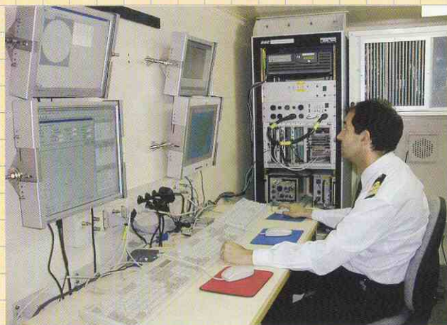
Interior del laboratorio móvil Link-16 "Movilink 16" desarrollado por el CIDA.
