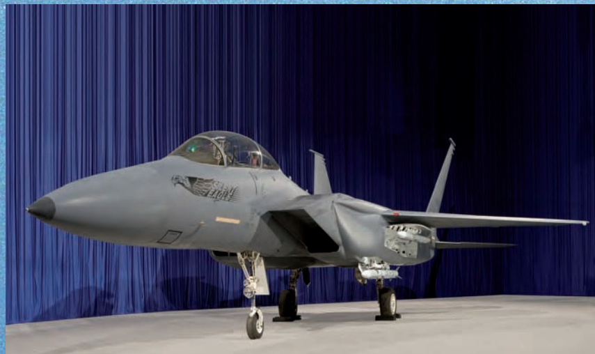
Boeing ha presentado una nueva versión del avión de combate F-15 Eagle, incorporando algunas características de invisibilidad a los sensores (Stealth).
