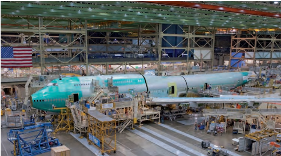
Instantánea tomada durante el proceso de unión de las secciones delantera y posterior del fuselaje del primer 747-8 Intercontinental. -Boeing-
