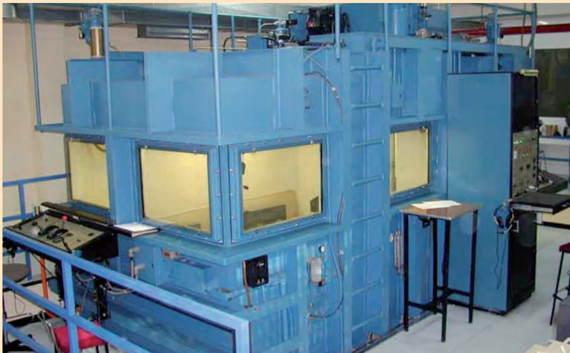
Figura 2. Cámara de baja presión (CIMA).
