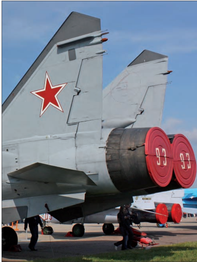
Detalle de la parte trasera del interceptor de largo alcance Mig-31BM, donde se aprecia el tamaño de sus enormes motores.
