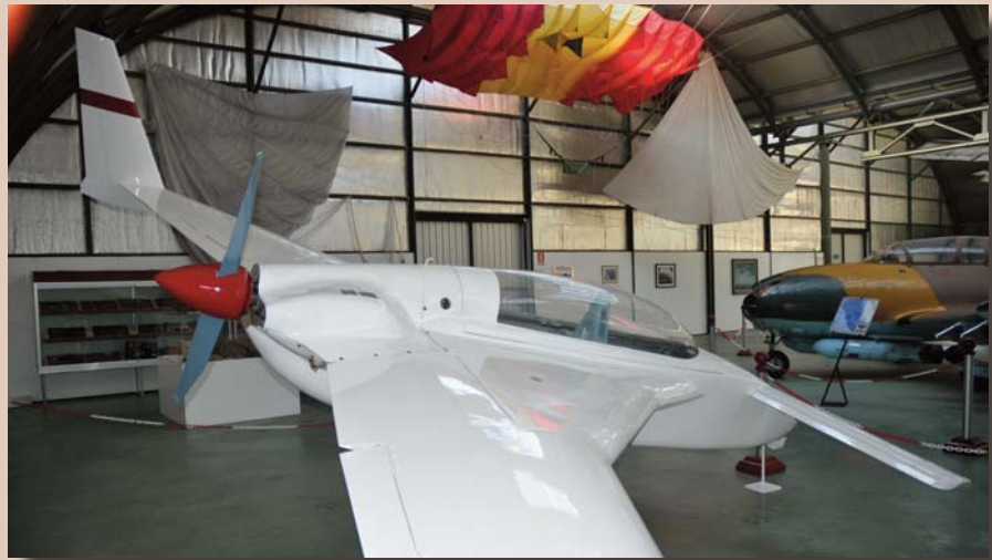
Estacionado en tierra, el tren de morro de retrae quedando el avión calzado sobre el tope de goma de la punta de morro, el motor trasero y la hélice impulsora presentan problemas de refrigeración.
