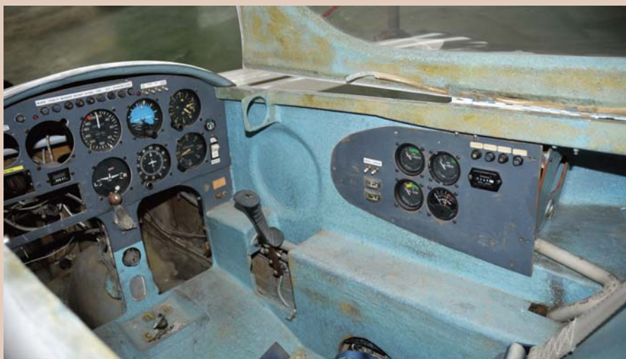
En la pequeña cabina delantera encontramos la palanca de mandos lateral, la manivela de retracción del tren de morro y el cuadro de control del motor y pilotaje del avión.
