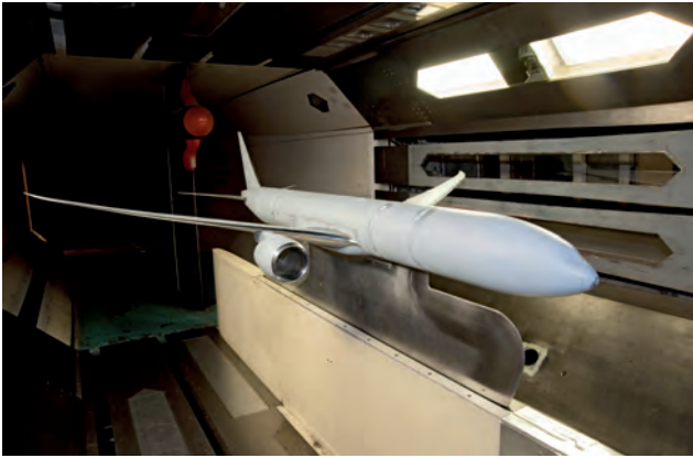
Maqueta de ensayos del Boeing 777X durante sus ensayos en el túnel aerodinámico transónico de Seattle. -Boeing-
