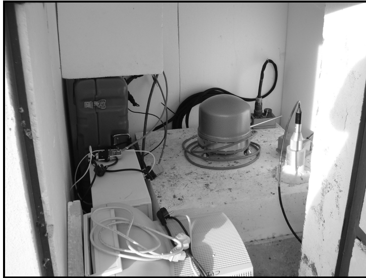
Figura 10: Sensores sísmicos de la estación de Banda Ancha EMAL.
