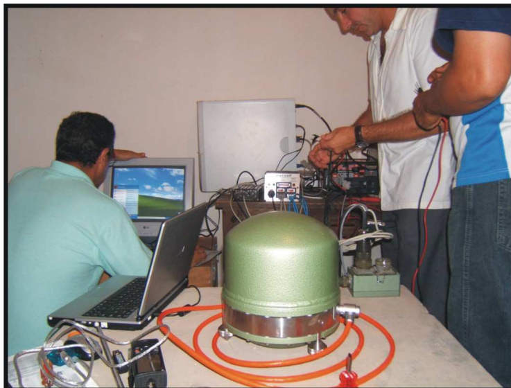
Figura 11: Instalación de la estación sísmica de Banda Ancha AVE (Marruecos).
