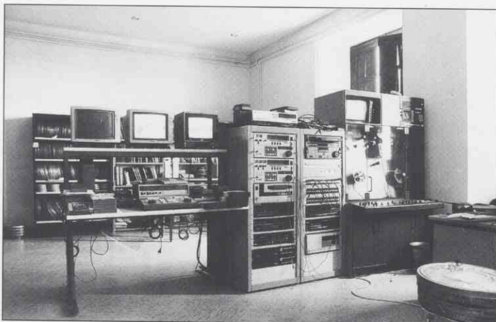
Fotografía 25. Telecine digital con el que se transforman toda clase de películas cinematográficas a soporte videográfico para su posterior archivo o distribución.
