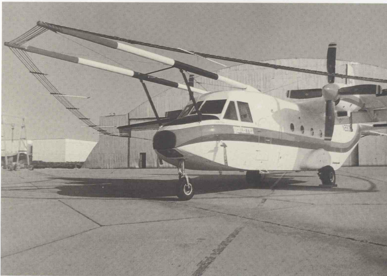
Probablemente el más insólito de los C-212 es este C-212-CC39 de Geoterrex preparado para prospecciones geofísicas. (CASA)
