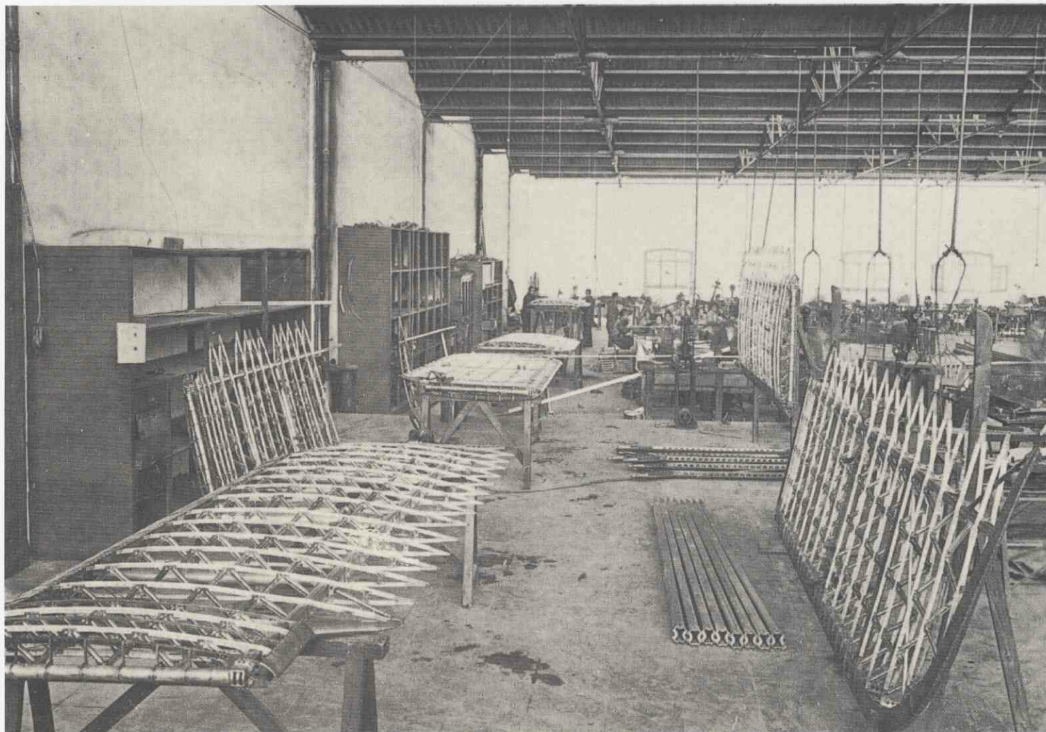
Líneas de producción de alas del Breguet XIX en la Factoría de Getafe. (CASA)
