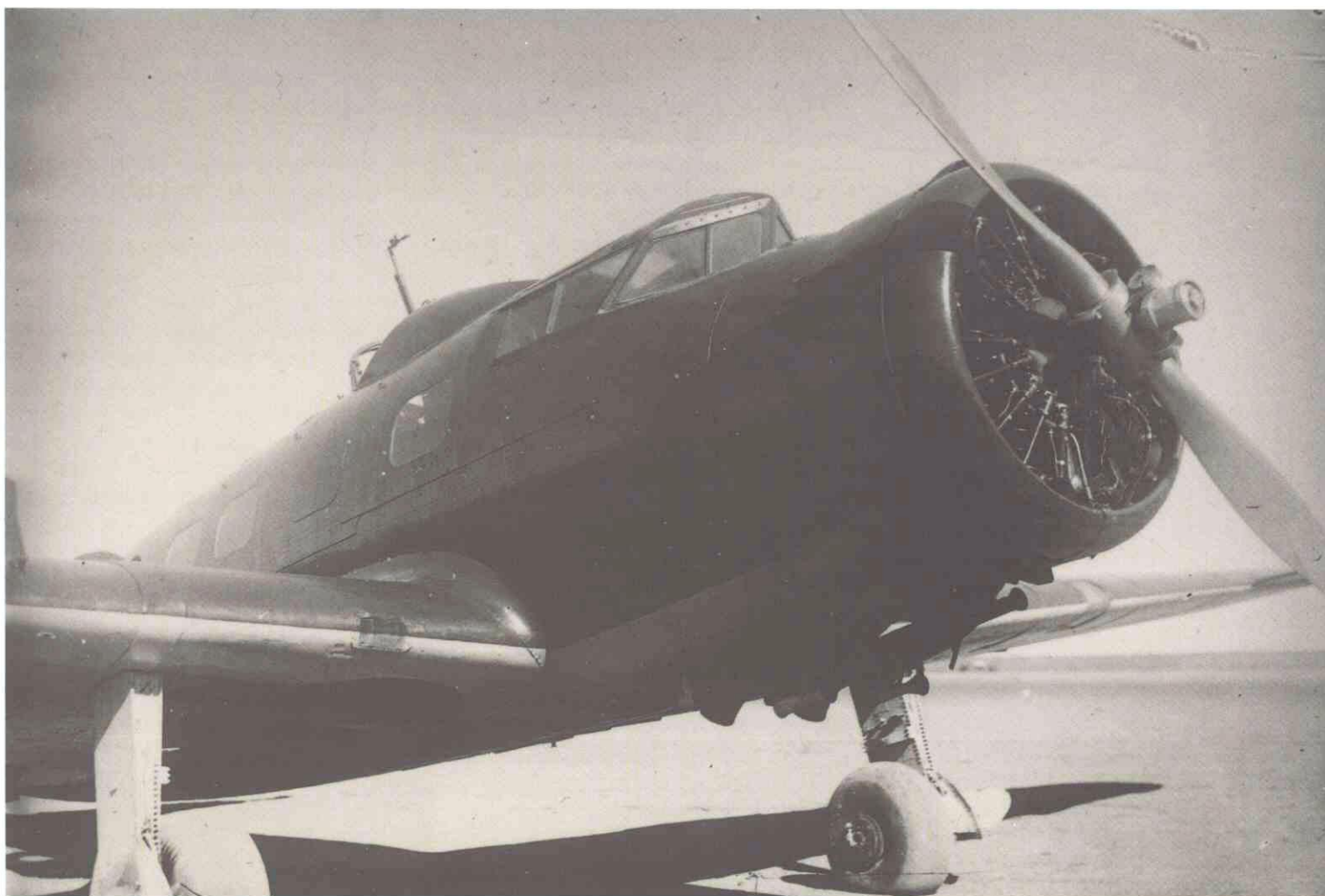
En este primer plano de un Vultee republicano puede apreciarse la característica joroba de protección del ametrallador dorsal, así como la inexistencia de lanzabombas externos.
