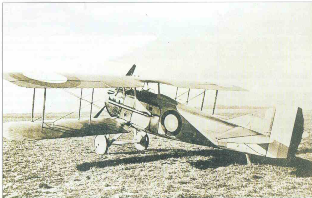
El Spad XIII C.1 fue el caza supremo de Francia en la Gran Guerra. Desarrollado a partir del Spad VII, usaba el motor Hispano-Suiza con reductor, más potente pero menos fiable que el de toma directa, y tenía dos ametralladoras sincronizadas. Fue probablemente el caza más rápido del conflicto.
