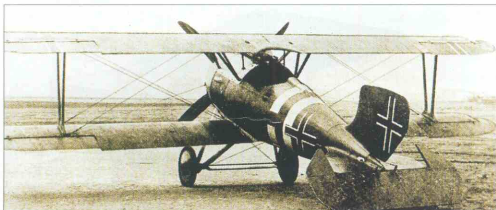
Siemens D III y D IV. La casa Siemens-Schuckert construyó en 1917 una sucesión de prototipos de caza que culminó en el D III. Este aparato, dotado del motor rotativo Siemens-Halske Sh IIIa de 160 cv, se reveló como un impresionante trepador, lo mismo que su sucesor el D IV. Problemas con el motor y las dificultades previas a la derrota de Alemania no ayudaron a que estos notables aparatos dieran todo lo que prometían. En la foto, un D IV.
