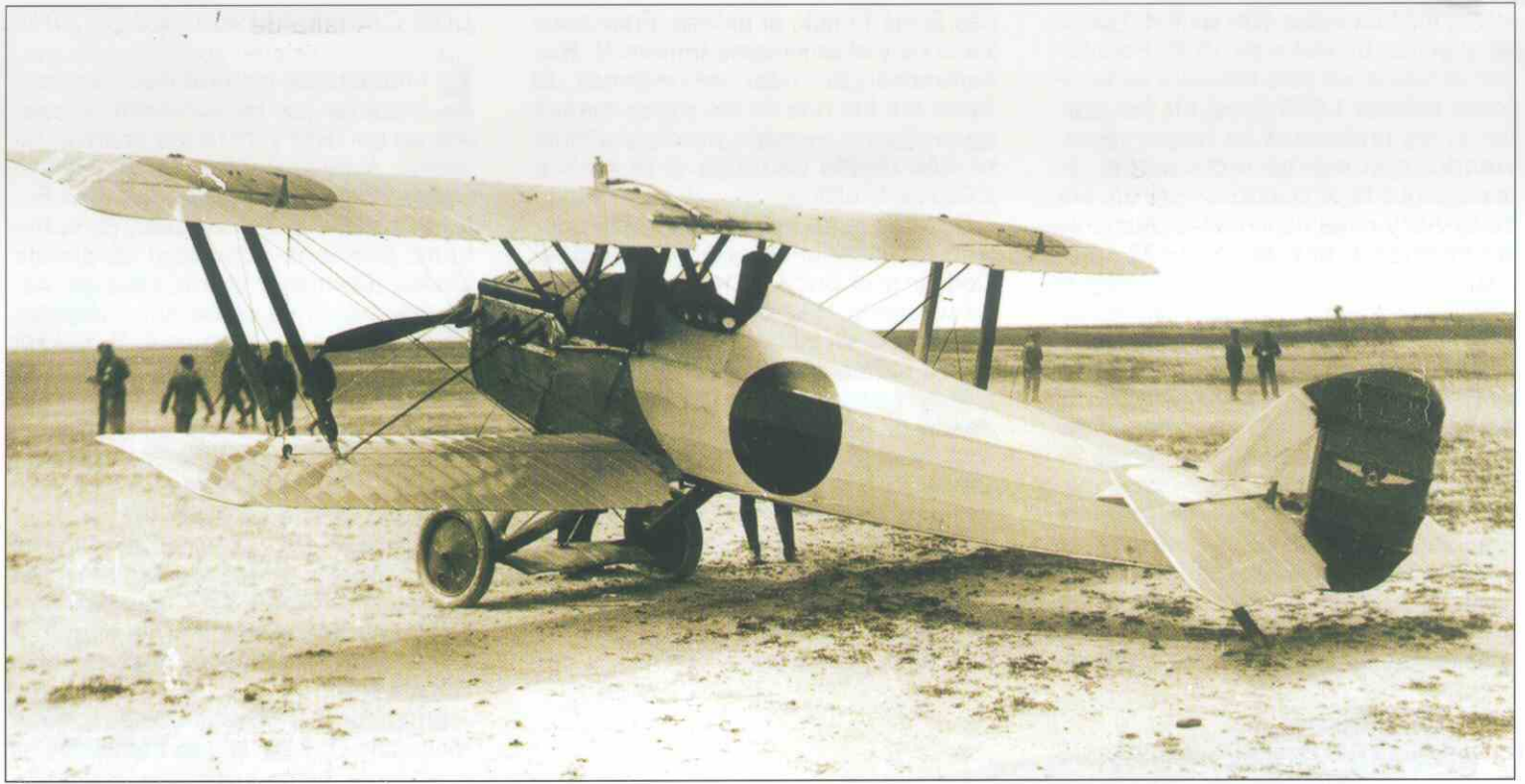
Hispano (Barrón) Caza (220 cv). Antes de dejar La Hispano, Barrón hizo una versión más potente de su caza, con el motor Hispano-suiza de 220 cv. aparte de otras diferencias menores, la nueva versión puede identificarse porque el reductor elevaba el árbol portahélice que, además, giraba ahora a izquierdas.
