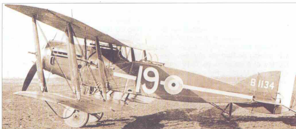
Bristol Fighter F.2B. Biplaza de caza-reconocimiento británico armado de una ametralladora sincronizada y una o dos de observador. Después de la guerra pasó al empleo de cooperación y fue tan satisfactorio que su producción en serie se reanudó. España usó en Marruecos varias escuadrillas de Bristol F.2B.
