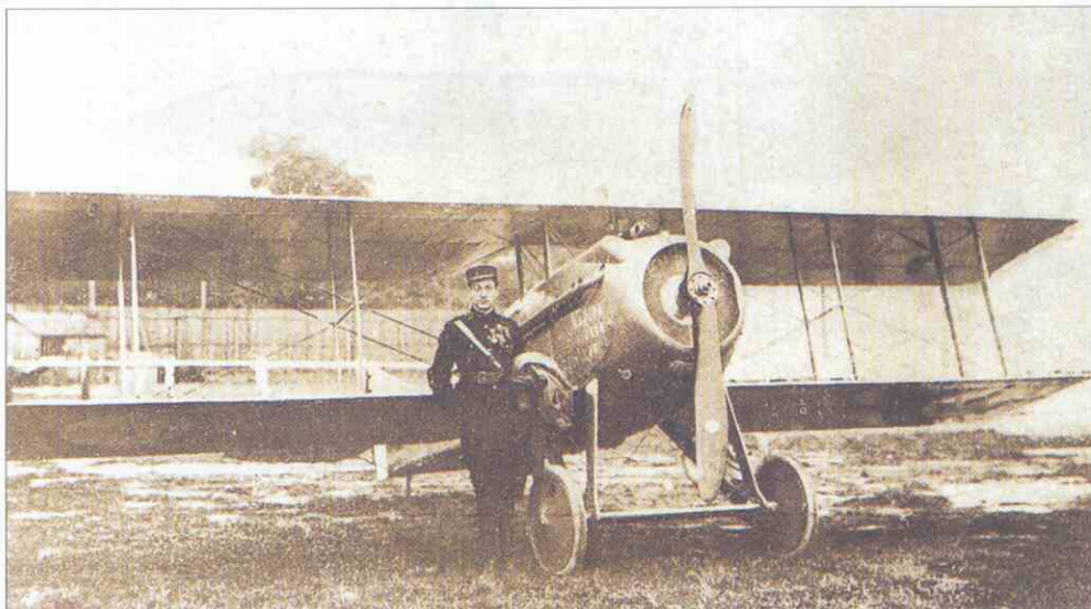
Spad VII C.1 de 180 cv. La foto, tomada de un anuncio francés de los motores Hispano-Suiza, muestra al as Guynemer con el aparato "con el cual abatí 19 aviones enemigos y que estaba dotado del primer motor Hispano Suiza 180 HP (que no fue nunca cambiado)".
