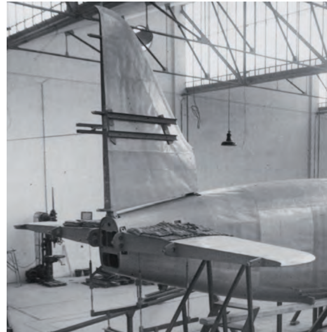
Ensayo del fuselaje a flexión y torsión realizado el 2 de noviembre de 1950, Benítez, subdirector de Proyectos de CASA.
