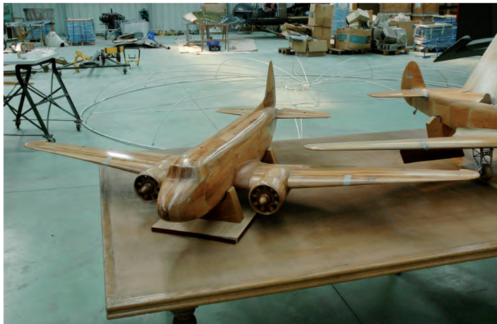
La maqueta de ensayos en túnel aerodinámico del C-202, hoy parte de la colección del Museo del Aire de Cuatro Vientos.
