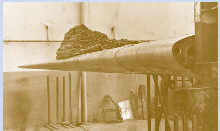
Ensayo de flexión del ala realizado el 8 de octubre de 1947
