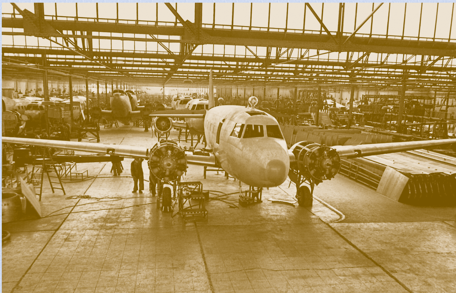
El primer avión de la preserie, que recibiría la matrícula militar T.5-3, durante su proceso de montaje. Nótese la presencia de la salida de emergencia superior sobre la cabina de vuelo
