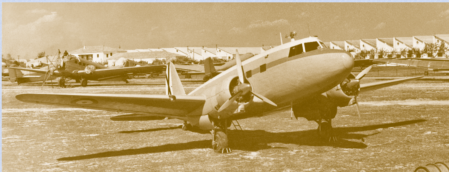
Esta fotografía sin fecha del T.5-3 en el exterior de la factoría de Getafe rodeado de C-352 (T.2), muestra que salió de la línea de producción sin las modificaciones de los estabilizadores y que, por lo tanto, fueron decididas a posteriori
