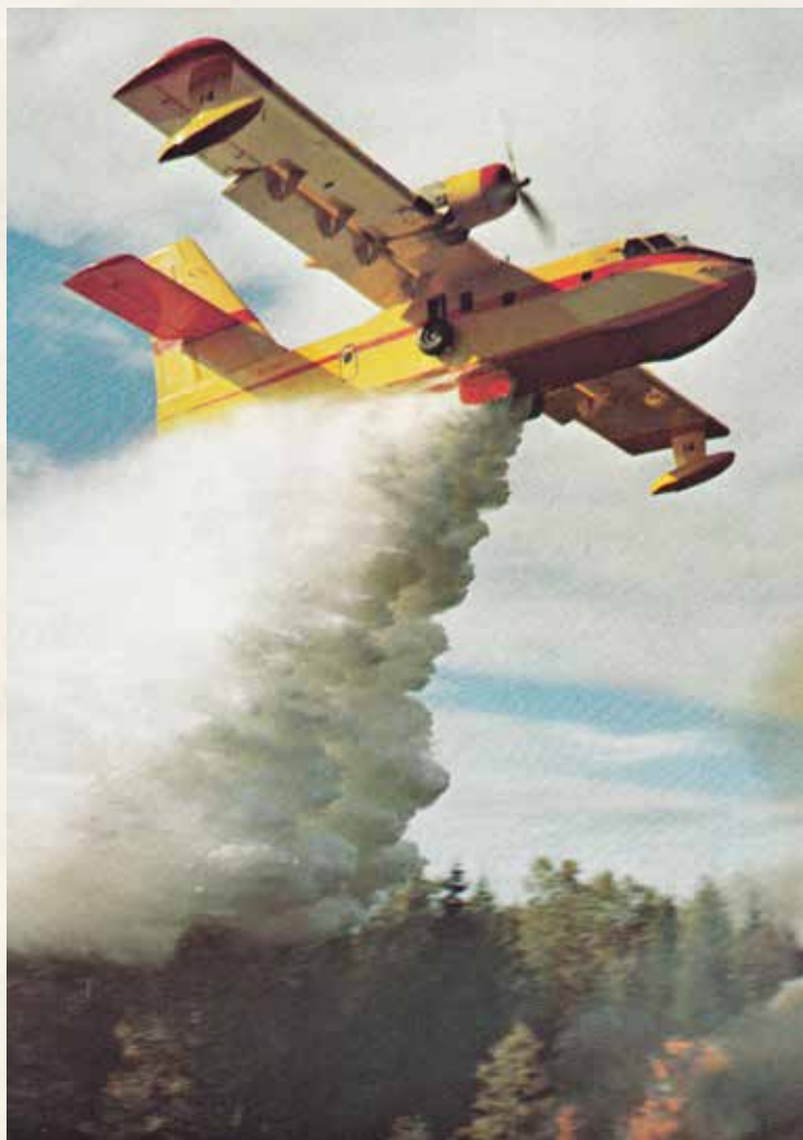
Avión Canadair CL-215, diseñado y construido especialmente para la lucha contra los incendios forestales
