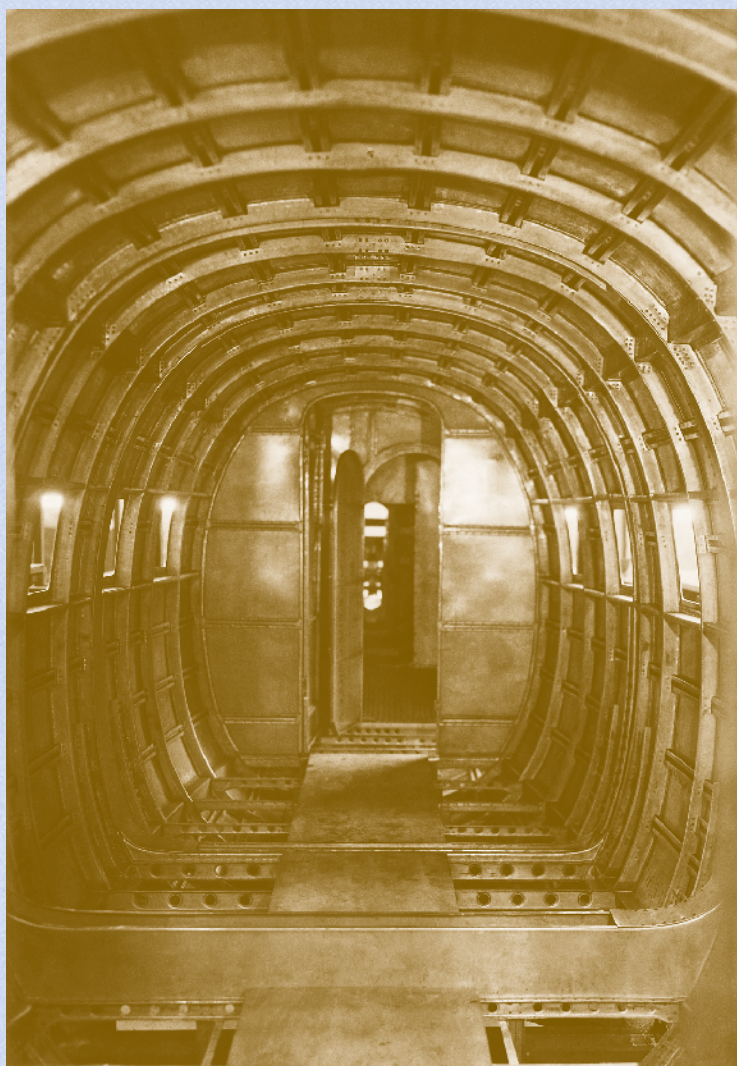
Vista interior en contra de la dirección de vuelo de la estructura del fuselaje del C-201
