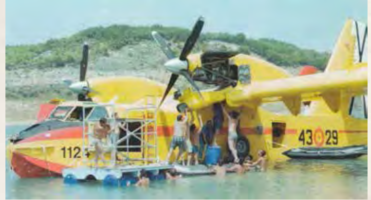
Cambio de un motor, con el avión estacionado en el embalse de Buendía
