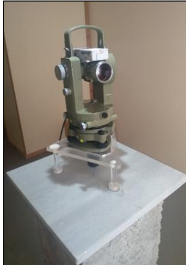
Figura 2: Declinómetro/Inclinómetro Bartington MAG-01H instalado en el teodolito modelo WILD T1.
