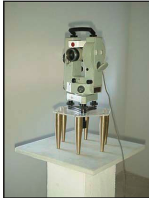
Figura 2: Declinómetro / Inclinómetro Bartington MAG01H
