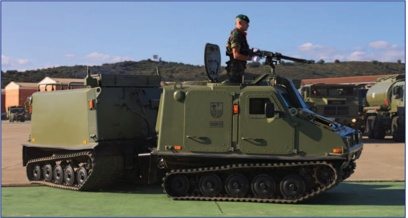
Vehículo tractor oruga todoterreno Bandvagn 206S. Crédito: Wikipedia.
