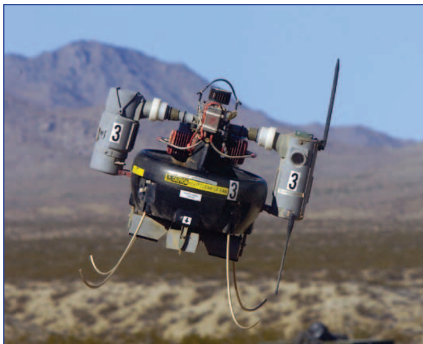
Micro-vehículo aéreo RQ-16 T-Hawk sobrevolando una zona de combate simulada durante un vuelo operativo de prueba. Crédito: United States Navy (Mass Communication Specialist 3rd Class Kenneth G. Takada).
