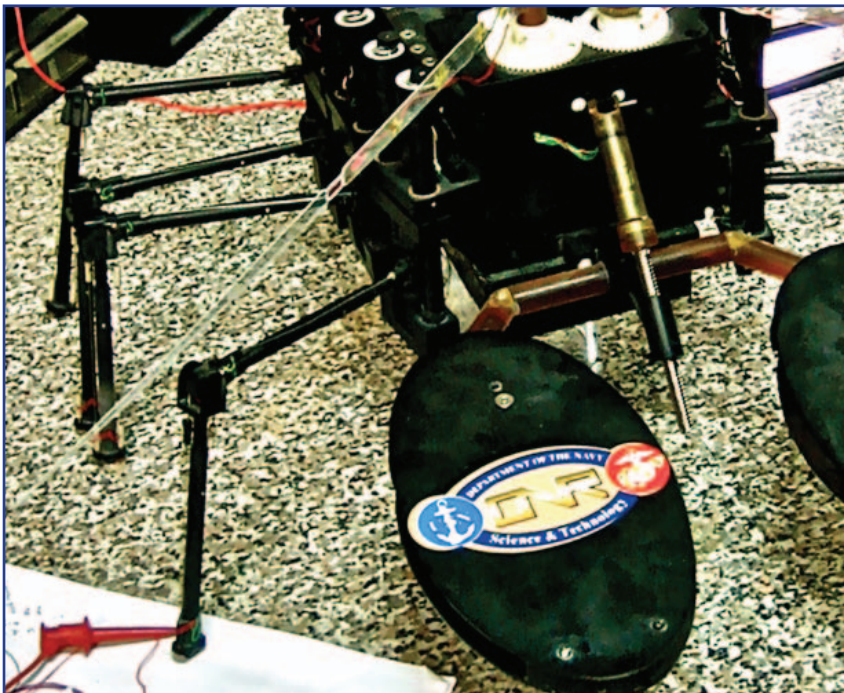
Este prototipo de robot de unos 60 cm de longitud y cerca de 3 kg de peso, apodado Robolobster, fue creado para localizar minas bajo el agua a profundidades entre 3 y 12 metros. Crédito: Elizabeth Johnson.
