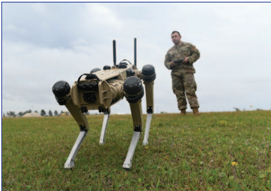
Prototipo de vehículo terrestre no tripulado dotado de capacidades avanzadas de vídeo multidireccional, térmico e infrarrojo, que permite una detección de amenazas basada en el uso de la inteligencia artificial. Crédito: U.S. Air Force (Airman 1st Class Anabel Del Valle).
