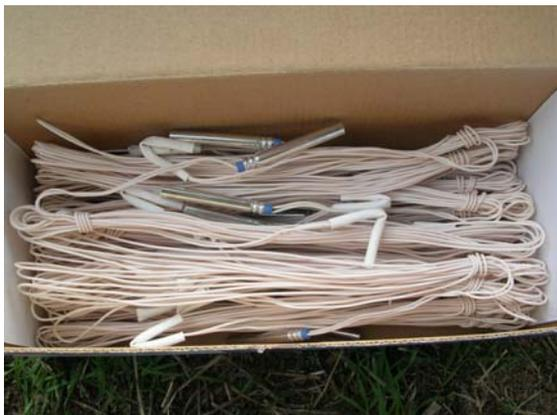
Como norma general los detonadores y espoletas serán transportados en otro vehículo diferente al que transporte la munición y explosivos.
