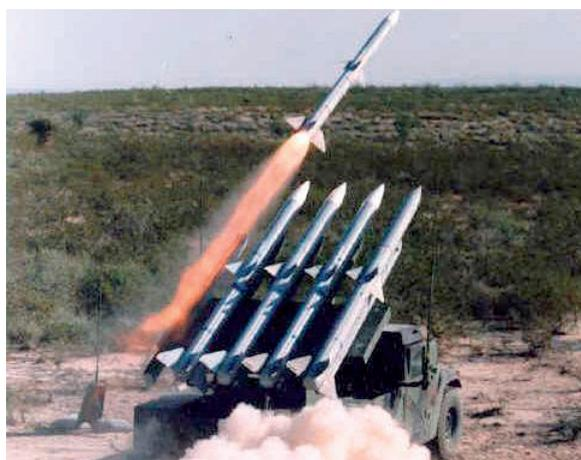
Entre los principales requisitos que se le exigen a este sistema destacan: su capacidad de transmisión de datos *Link 16*, ser empleado sobre vehículo de alta movilidad táctica y una gran capacidad de proyección, facilitando el aerotransporte en aviones tipo C-130.
