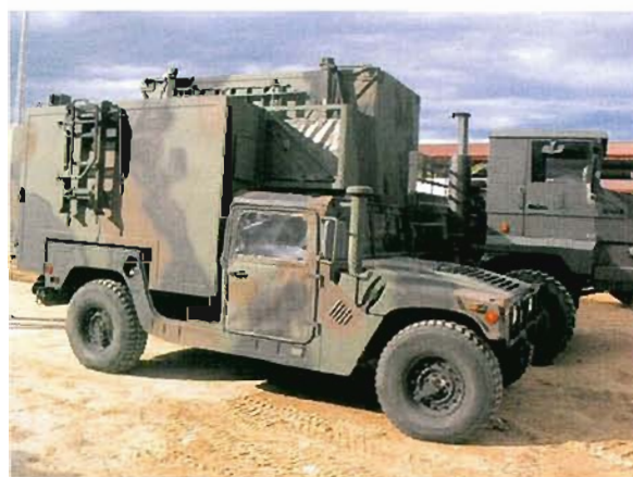
En la imagen, los futuros vehículos/material del GEDE de la BRIMAR Hummer 1097, con Shelter EOD de Mando y Control, y justo detrás, Camión 7226 con contenedor NATO II, específico para transporte del material EOD.
