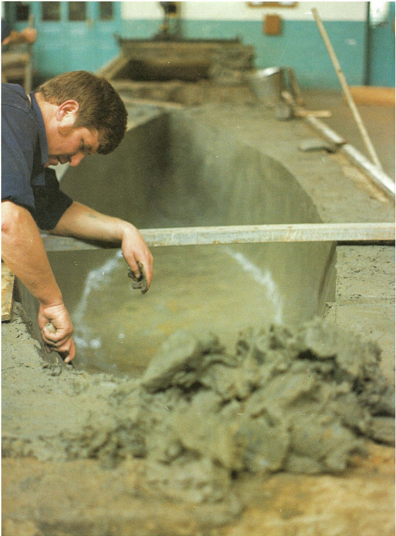
Dos momentos del proceso de fabricación de un modelo de carena: Sobre estas líneas, confección de un fondo de barro; derecha, modelo macho.
