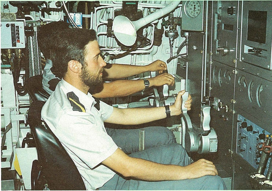
Cámara de Mando en donde se efectúa el control de la seguridad en inmersión, a través de un puesto de gobierno totalmente automático que no precisa intervención alguna, salvo en caso de emergencia; en tal supuesto, desde aquí se gobiernan los timones de buceo y el timón vertical.
