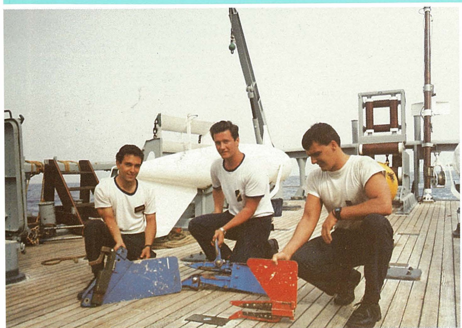
Componentes de la dotación del «GUADALQUIVIR» nos muestran los tres tipos de «CUCHILLAS» que se utilizan en el rastreo mecánico para limpiar una zona sembrada con minas de orínque.
