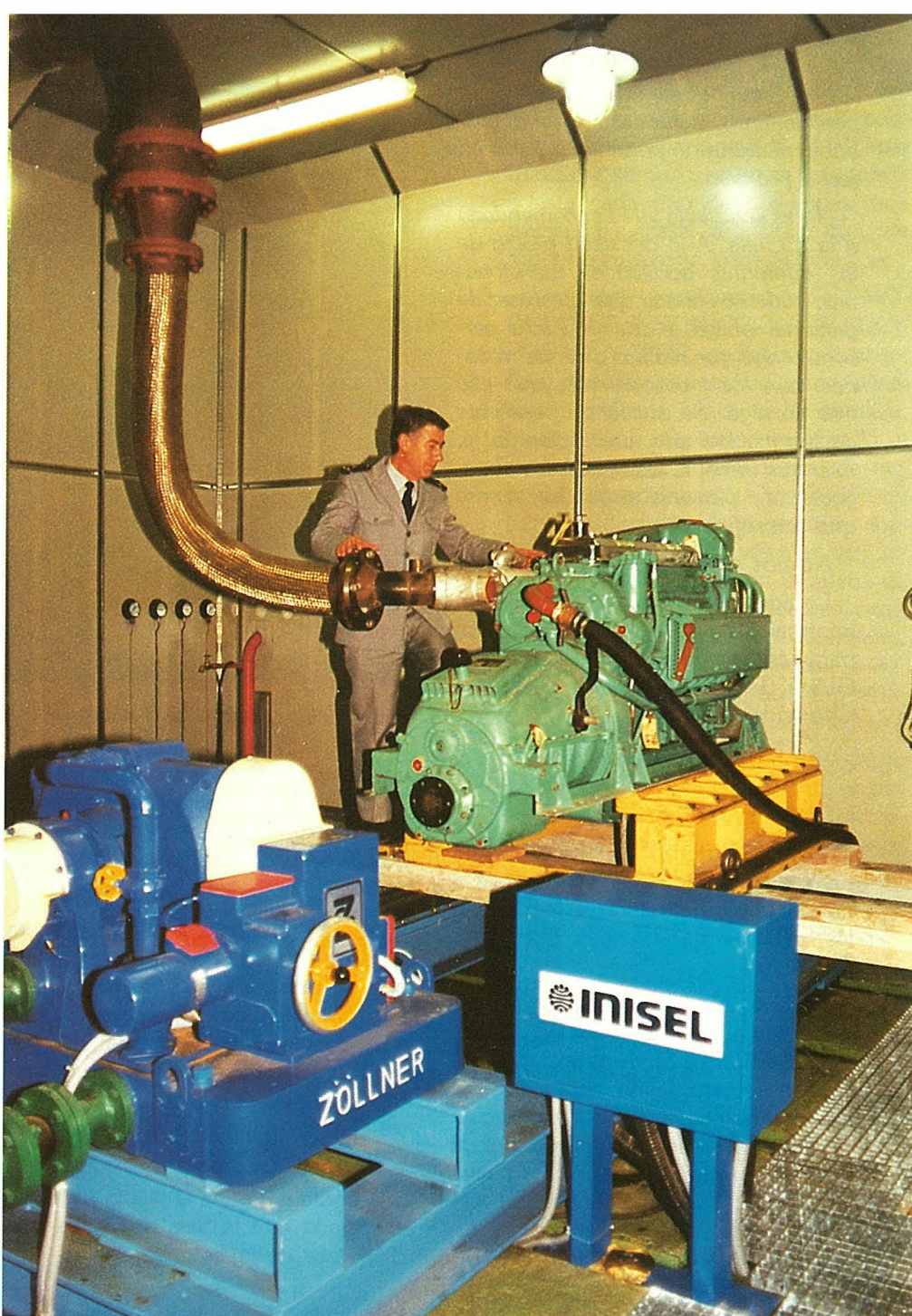
Módulo de Instrucción de motores. Banco de pruebas de motores de baja potencia.
