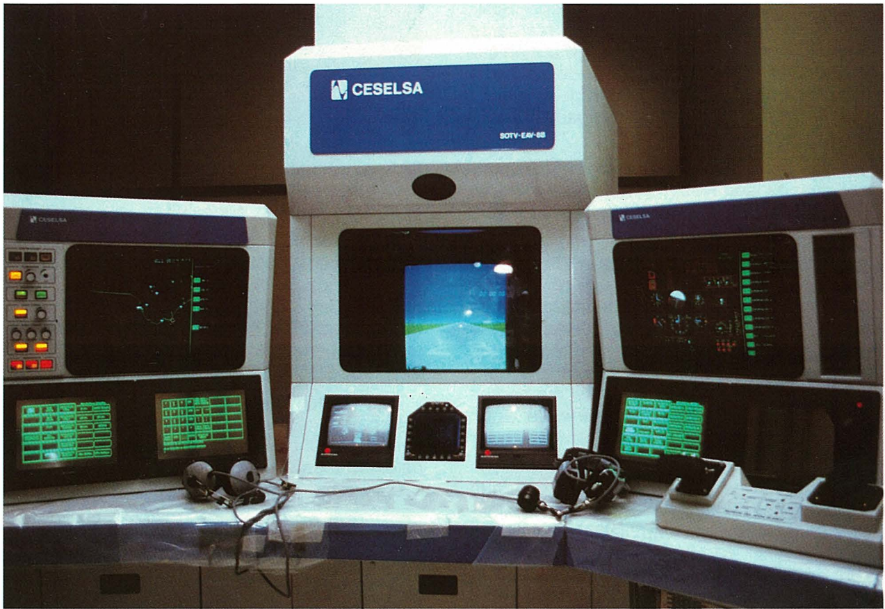
La Compañía Española CESELSA ha suministrado el simulador de vuelo del Harrier II "Bravo" a la Armada. En la foto, el sistema de generación de imágenes por ordenador.
