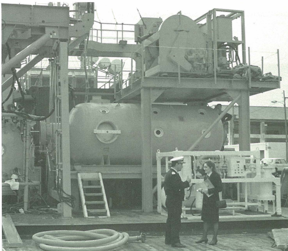
Detalle del complejo hiperbárico que monta el A-102 "MAR ROJO". Es la primera vez que un barco lleva el equipo de descompresión completo en nuestro país.
