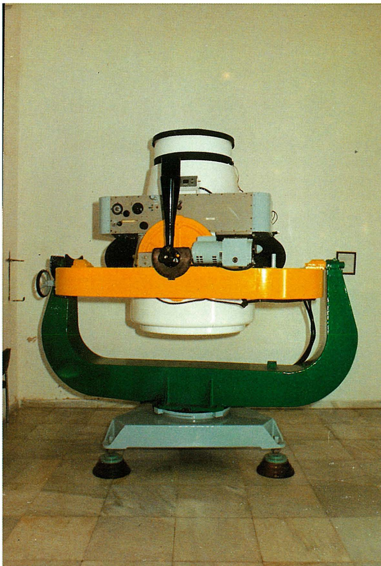
Cámara fotográfica para seguimiento de satélites artificiales.
