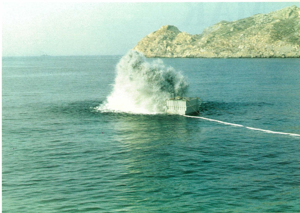
Modelo parte central de Cazaminas a escala 1/3 para ensayos de choques
