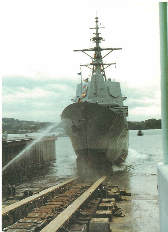
En el momento de la botadura, el buque experimenta un desplazamiento de un 80% del peso total que tendrá el día de su entrega a la Armada. Este elevado porcentaje de acabado a la hora de la botadura es consecuencia de la aplicación de la tecnología modular de la empresa nacional IZAR.
