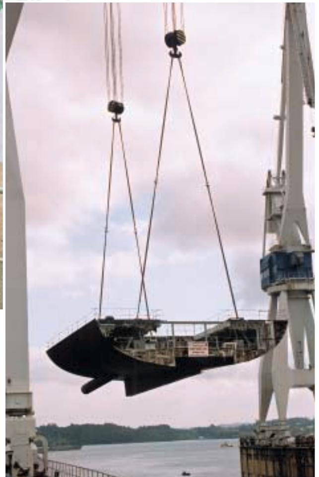
Puesta en quilla de una sección de la cuarta y última fragata de esta serie, la F-104 Méndez Núñez .
