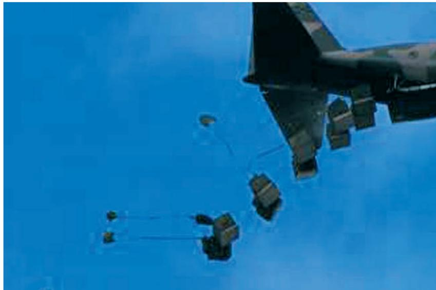
*Lanzamiento de cargas por el sistema de gravedad*
