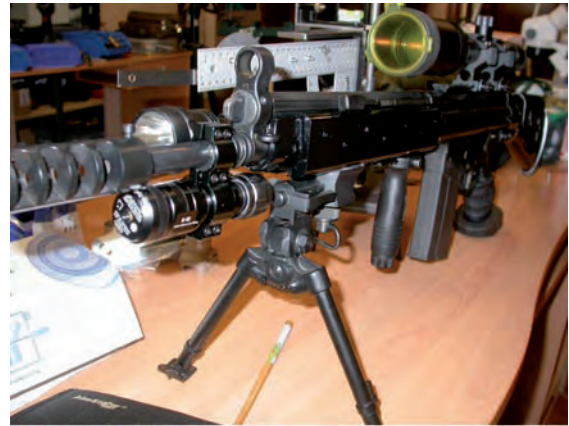
En su parte inferior detalle del bipode Versa-Pod acoplado mediante una guía interna del guardamanos fabricado en duraluminio observen el designador láser Green y la linterna táctica a la izq. Del GM.
