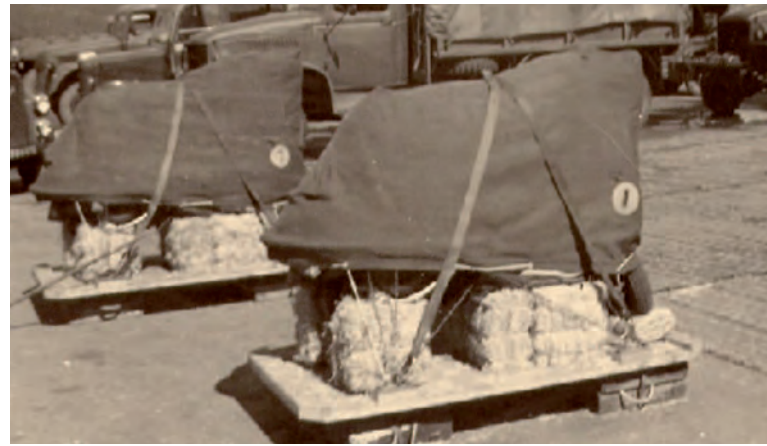
Vespa 150 TAP Preparadas para el lanzamiento, donde podemos observar la paja para amortiguar el impacto.
