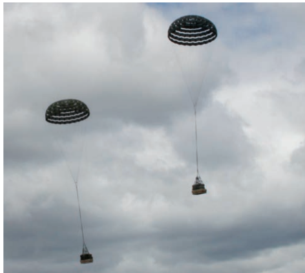
Descenso de las cargas con sus paracaídas estabilizadores
