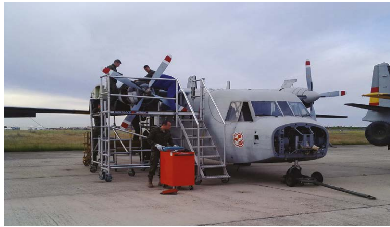
Desmontando los motores
