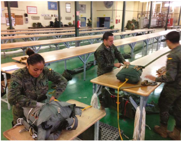
Trabajos de plegado de un paracaídas principal
