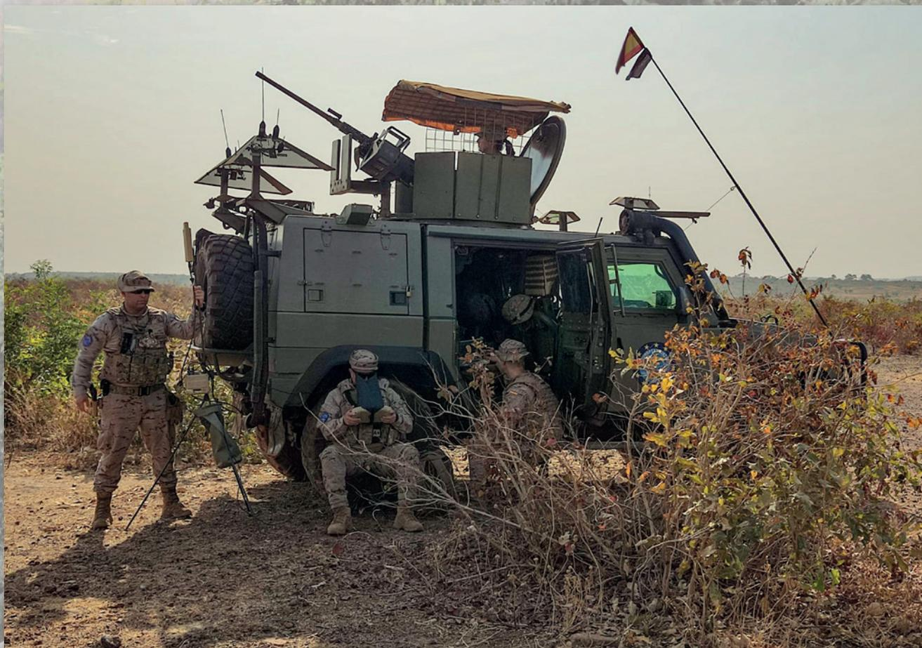
Equipo UAV Raven realizando un control de vuelo
