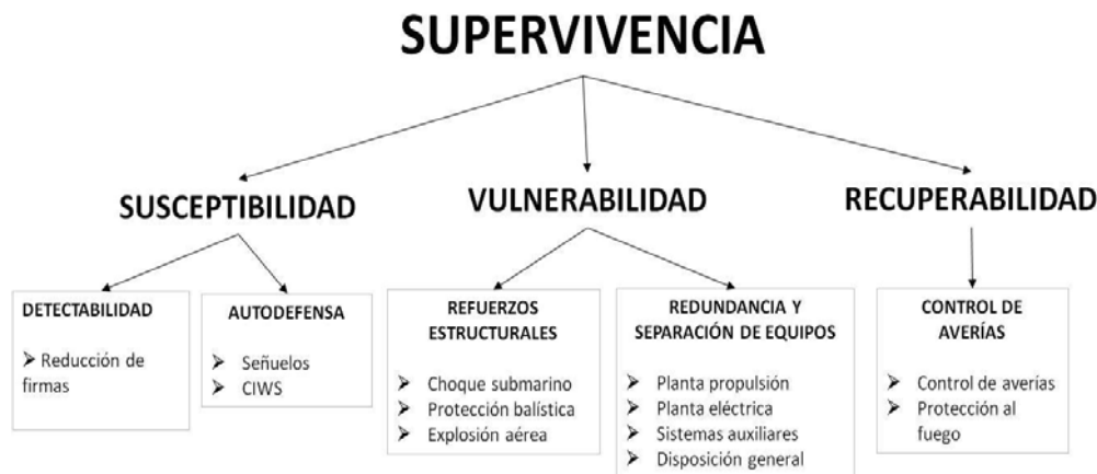
Figura nº. 3 Componentes de la supervivencia de un buque
