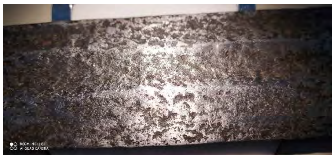
Figura 67. Detalle de cráteres que se observan en toda la hoja 50X aumentos. Lupa de aumento. (Fuente: el autor)
