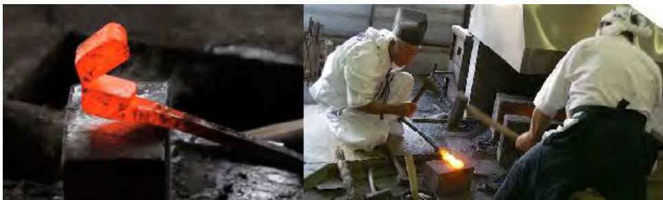
Figura 35. Imagen de forjado sobre plegado (Fuente: The folding process of the Japanese sword 37 )
