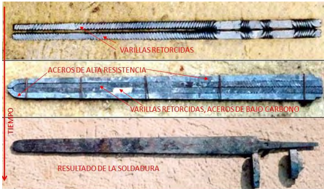
Figura 10. Patrones en función. Disposición de las varillas a soldar y soldadura. (Fuente: Patterns in pattern-welded swords. Patrick Barta 13 )
