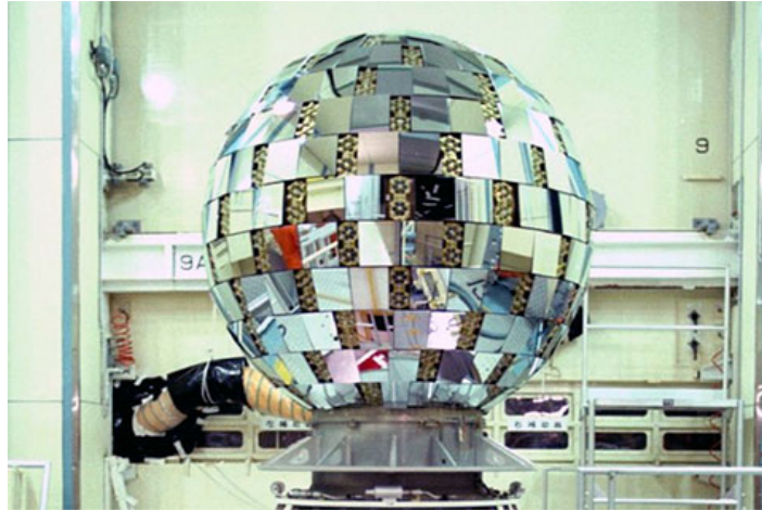
Figura 2.1: Satélite geodésico experimental AJISAI lanzado por JAXA (Japan Aerospace Exploration Agency) en 1982. En la imagen se observa una clara diferencia entre los espejos y los retrorreflectores. Imagen extraída de [16]
