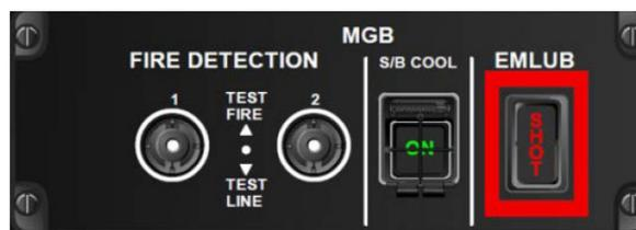
Caja de control del sistema de lubricación en emergencia
