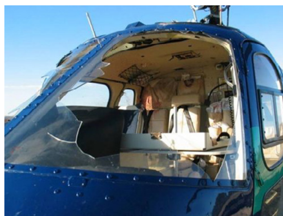
Impacto de ave en cabina
