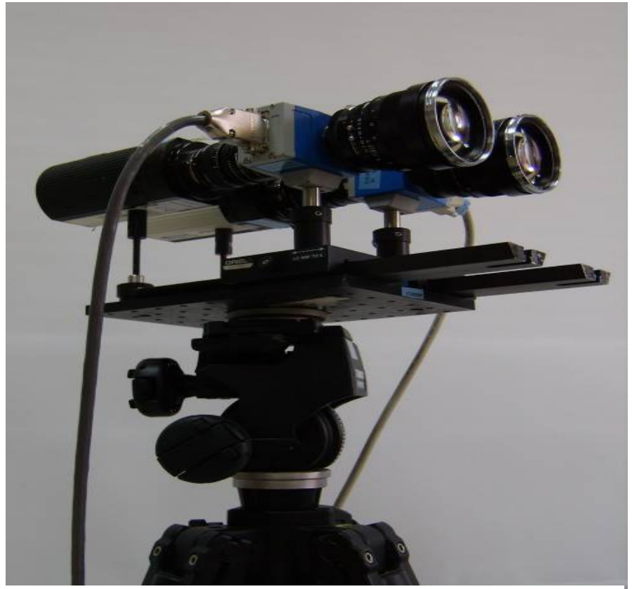
Fig. 1. Configuración del sistema imagen hiperespectral en visible.
