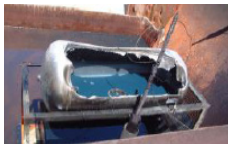
Fig. 6. Estado del depósito que no contenía la malla metálica en su interior después de haberlo sometido a fuego directo.
