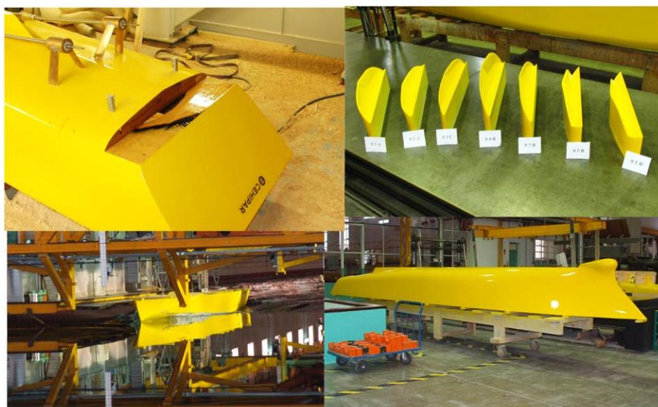
Fig. 1. Detalle constructivo de las distintas configuraciones de colas de pato
