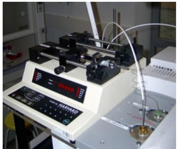
Fig.3. Sistema inyección automático. (Fuente: elaboración propia).
