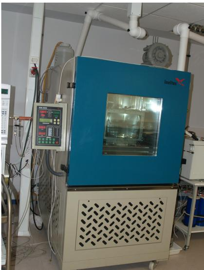
Fig. 5. Cámara climática. (Fuente: elaboración propia).
