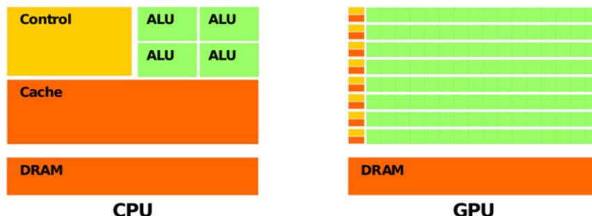
Fig. 1. Comparación entre las arquitecturas de una CPU de 4 núcleos y una GPU. (Fuente: <http://gpgpu.org/sc2007> *SuperComputing Tutorial 2007*, introducción de David Luebke).
