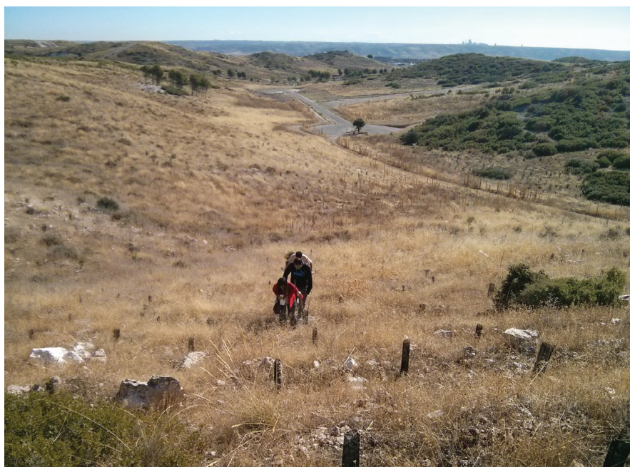
Fig. 6. Ensayo con tres personas caminando con separación radial de tres metros en zona de clutter intenso debido al elevado desnivel del terreno. (Fuente: Advanced Radar Technologies S.A)
