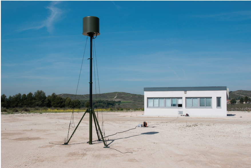
Fig. 3. Instalación temporal del radar en el ITM, empleando un mástil para despliegue rápido en campo. (Fuente: Advanced Radar Technologies S.A)
