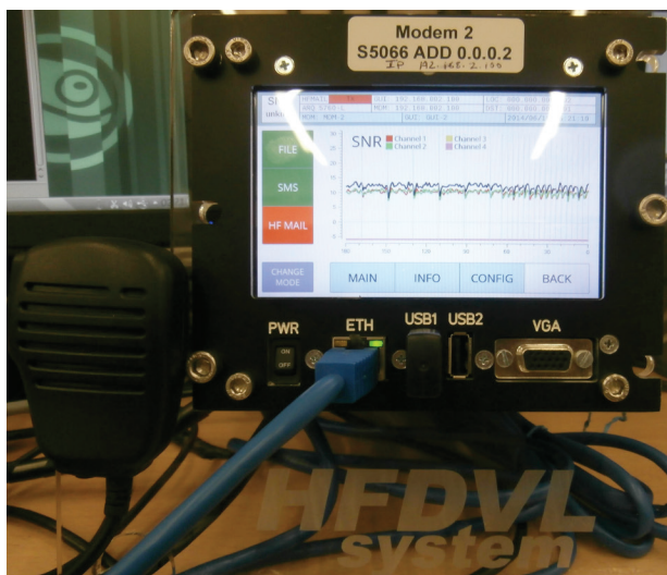
Fig. 6. Sistema HFDVL con STANAG 5066 trabajando en modo local y remoto. (Fuente propia).
