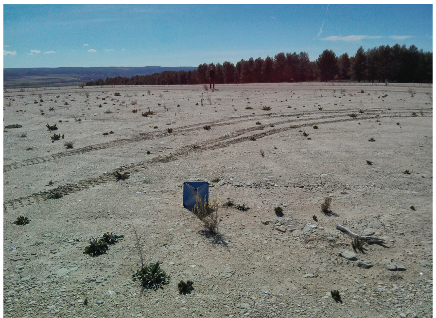
Fig. 4. Reflector tetraédrico en zona de bajo nivel de clutter en el ITM. Procedimiento de calibración del sensor. (Fuente: Advanced Radar Technologies S.A)
