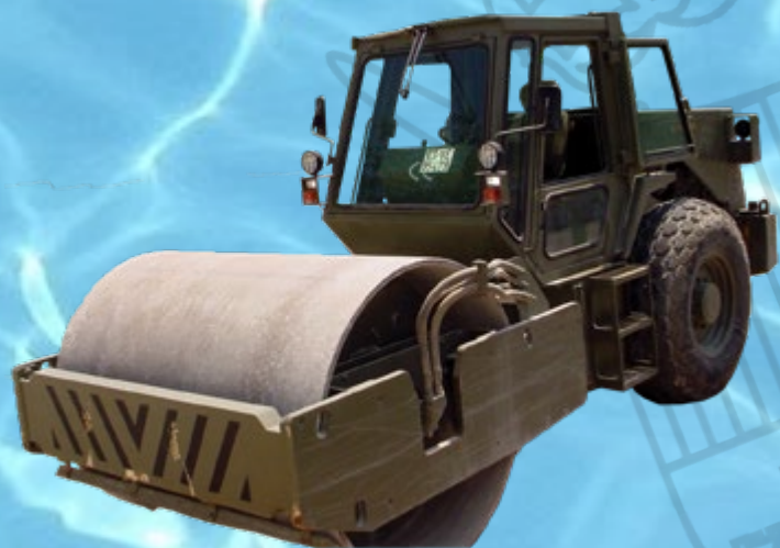
RODILLO VIBRANTE LEBRERO RAHILE AUTOPROPULSADO
