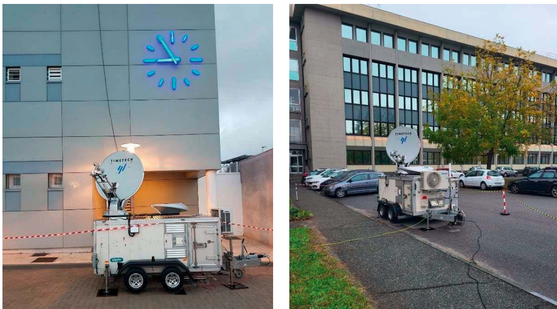
Figura 4.9: Estación portátil TWSTFT en el ROA (izqda.) y en el INRIM (dcha.).
