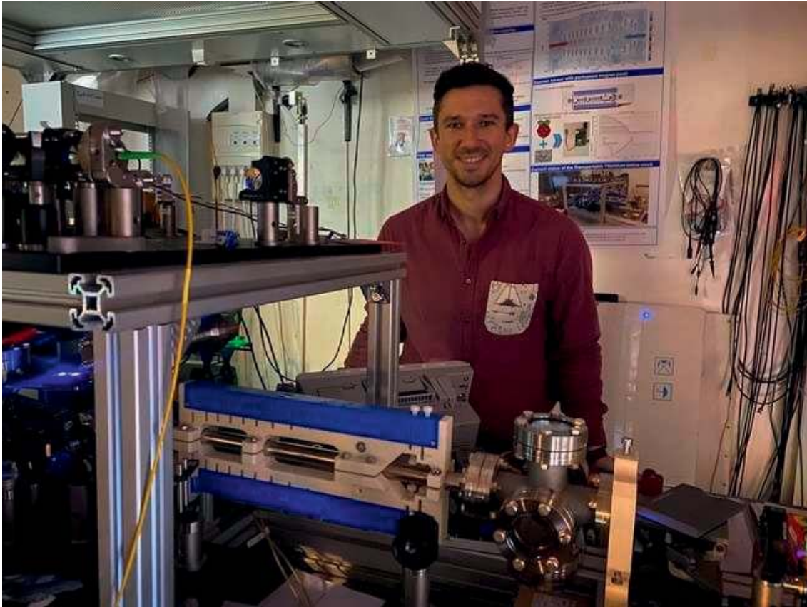
Figura 4.14: El TN Jesús Romero frente al reloj óptico de Iterbio, donde se puede apreciar el ralentizador Zeeman instalado en el reloj. Foto cortesía de OP-SYRTE (París).
