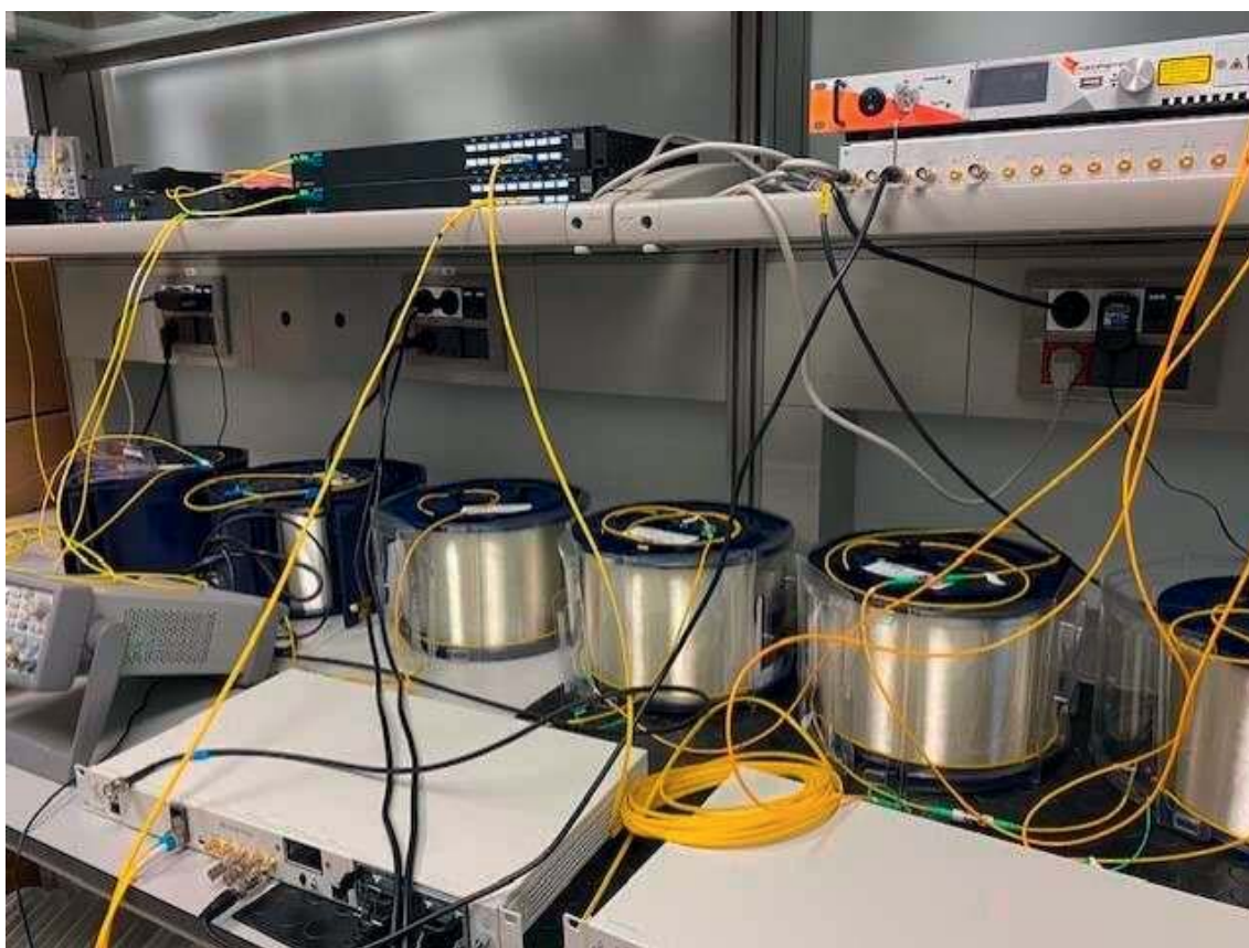
Figura 4.17: Enlace local de larga distancia (250 km) mediante tecnología White Rabbit .
